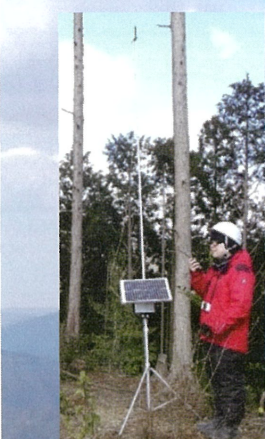
中継機で操作範囲拡大 バッテリー+ソーラー発電
