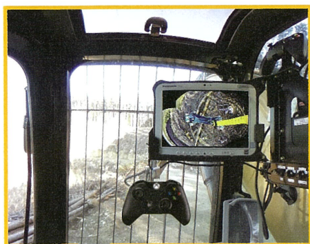
中継機で操作範囲拡大 バッテリー+ソーラー発電
