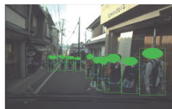
タグ情報表示・レーダ点群の重畳表示例
